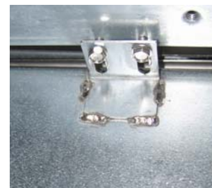
Afbeelding 5: Bevestig de smelter aan beide zijden op de rails.
