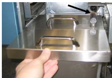
Afbeelding 4: Plaats het deksel op de pan en schuif de olieslang in het vrouwelijke gedeelte van de zuiger.
