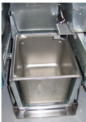
Afbeelding 3: Plaats de binnenste oliereservoirpan in de smelter.
